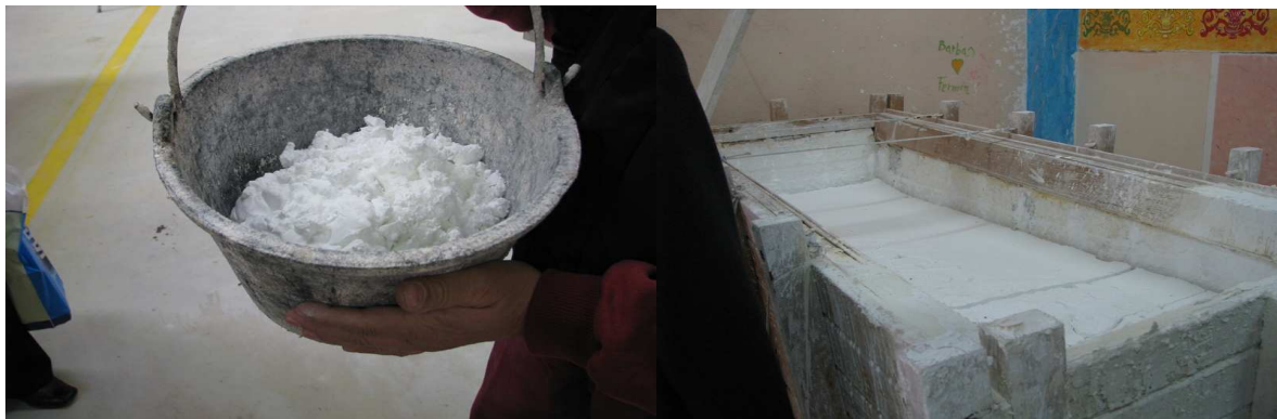
Po 10 minutach zaczyna się proces gaszenia wapnia, następnie wapno przechowywane jest dłuższy czas w drewnianych skrzyniach
