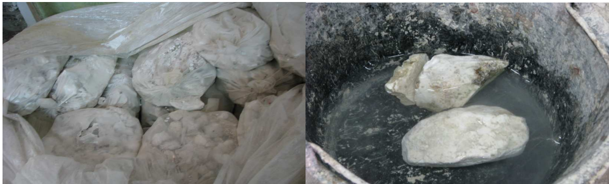
Wypalony kamień wapienny przechowywane są w workach foliowych, aby nie zawilgły, bryły wapna palonego wrzucone do wody.
