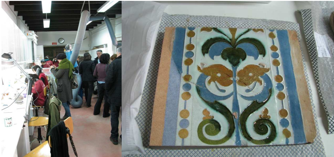
Widok pracowni konserwacji ceramiki obok kafel, w którym ubytki warstwy barwionego szkliwa uzupełniane były aerografem.
