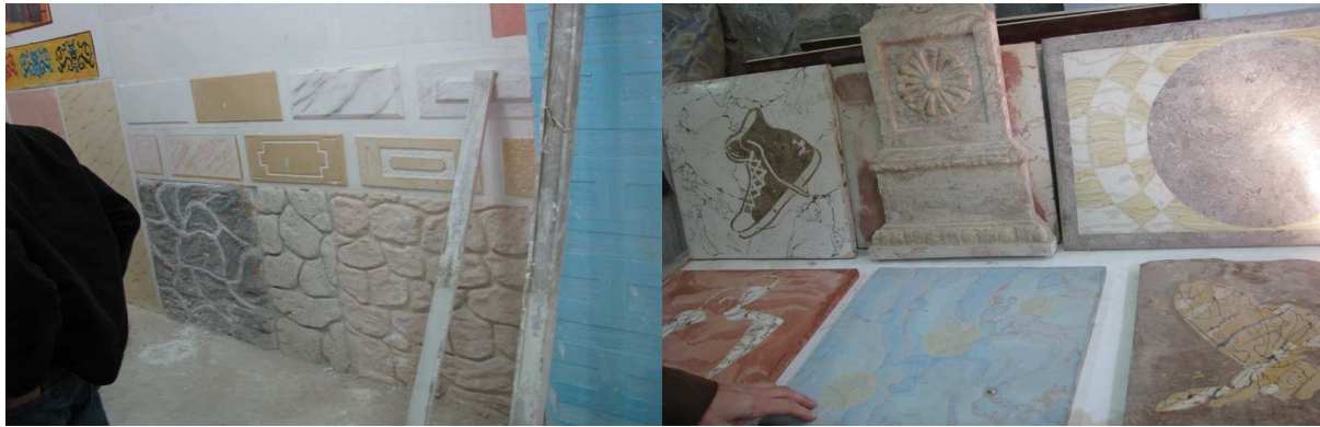
Próbki różnych technik wykonane przez studentów w trakcie kursu. Płytki wykonane metoda stucco lustro.
